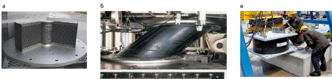
Резинометаллическая сейсмоизолирующая опора со свинцовым сердечником
