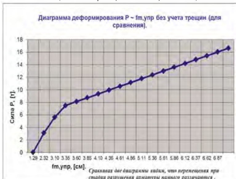
Рис.2. Зависимость сила P (по ординате) ~ перемещения f (по абсциссе) в упругой стадии. (Значения силы приняты из столбца №22 табл.1, значения перемещений из столбца №26 табл.1).
