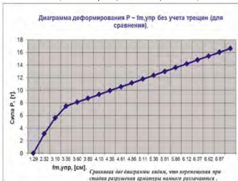
Рис.2. Зависимость сила P (по ординате) ~ перемещения f (по абсциссе) в упругой стадии. (Значения силы приняты из столбца №22 табл.1, значения перемещений из столбца №26 табл.1).
