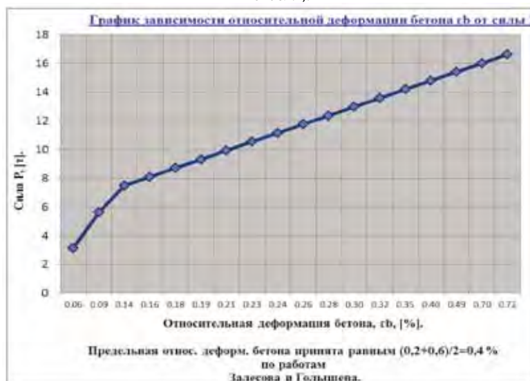
Рис.3. Зависимость сила P (по ординате) ~ относительная деформация сжатой зоны бетона \epsilon_b (по абсциссе). (Значения силы приняты из столбца №22 табл.1, значения относительной деформации бетона из столбца №17 табл.1).
