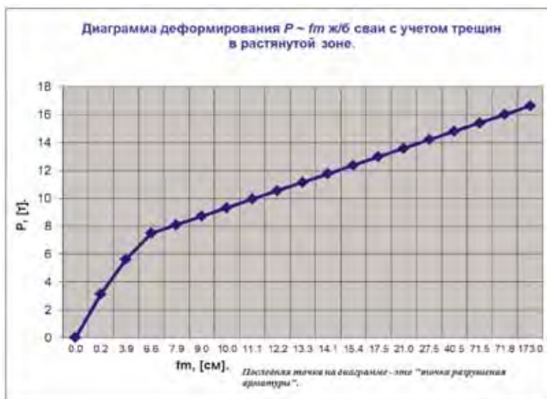
Рис.1. Зависимость сила P (по ординате) ~ перемещения f (по абсциссе) с учетом упругопластической работы ж/б сваи. (Значения силы приняты из столбца №22 табл.1, значения перемещений из столбца №23 табл.1).
