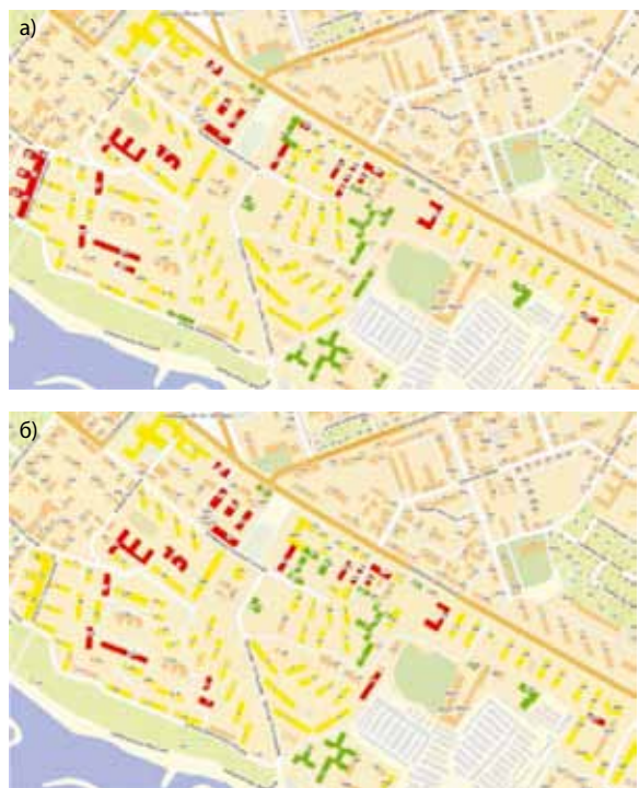
Рис.1. Оценка дефицита сейсмостойкости на основе визуального обследования (а) и визуального и инструментального обследования (б); зеленому уровню соответствует хорошее техническое состояние и отсутствие дефицита сейсмостойкости, желтому уровню — удовлетворительное и не вполне удовлетворительное состояние зданий и дефицит сейсмостойкости до 1 балла, красному уровню соответствуют удовлетворительное и не вполне удовлетворительное состояние зданий с дефицитом сейсмостойкости более 1 балла.
