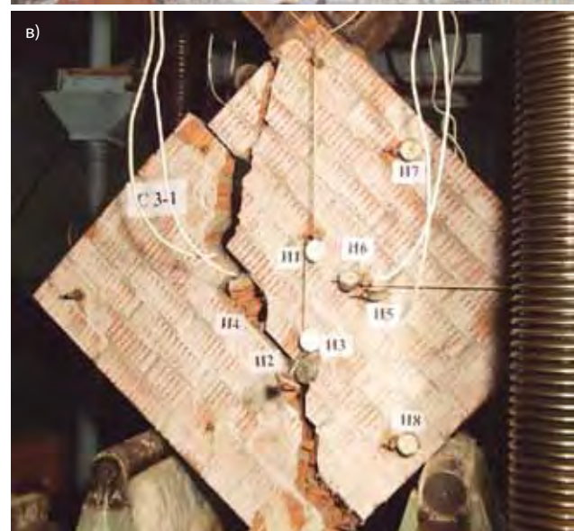
Рис.4. Разрушение образцов первой серии: а) С1-1 в зоне приложения нагрузки; б) С1-2 в опорной зоне; в) С1-3 образование диагональной трещины.
