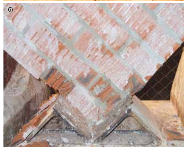
Рис.3. Общий вид образца первой серии в испытательном прессе
